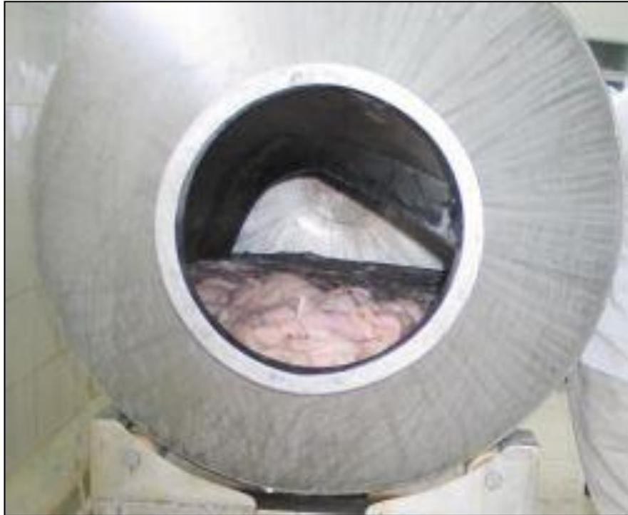
**Aplicação de STPP com uso de tumbler com vácuo**
